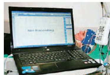
▲ Prijenosni EEG uređaj najnovije generacije s multidisciplinarnom primjenom i programskom podrškom za tele-EEG.
