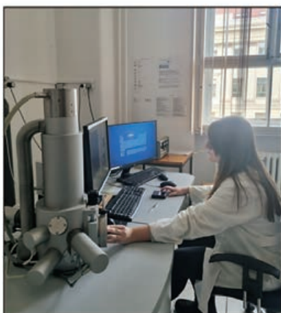
Gornji red: model kritičnog defekta ulne u kunića te 3D rekonstrukcije regeneriranih defekata primjenom različitih osteoinduktivnih formulacija. Donji red: Analiza uzoraka sintetičkih keramičkih čestica na skenirajućem elektronskom mikroskopu
